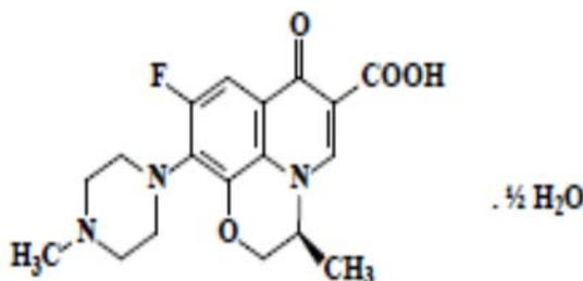
Propriétés physicochimiques : La lévofoxacine est une poudre cristalline jaune pâle à brillant dont le point de fusion est de 226 à 227°C. Ses valeurs de  $pK_a$  sont de 5,33 pour la  $pK_{a1}$  et de 8,07 pour la  $pK_{a2}$ . La molécule existe sous forme d'ion dipolaire (zwitterion) aux conditions de pH existant dans l'intestin grêle.
