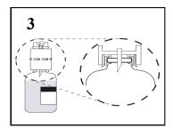
7. Tenir la fiole de diluant munie du dispositif de transfert en position inclinée par rapport à la fiole de concentré afin d'éviter que le diluant ne s'écoule (Fig. 4).
