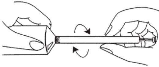
2. En pressant le tube à la base, remplissez l'applicateur jusqu'à ce que le trait rouge sur le piston soit visible.
