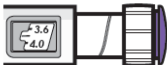
Fenêtre d'affichage de la dose indiquant 3,8 mg
