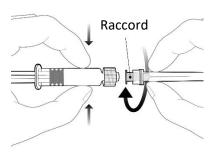
Pour fixer l'aiguille, insérer le raccord dans l'adaptateur Luer Lock et le faire tourner d'un quart de tour dans le sens des aiguilles d'une montre jusqu'à ce qu'il se bloque.
