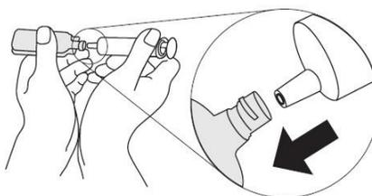
**1.b. Système Luer Slip :** Insérez le moyeu de la seringue dans l'ouverture de l'ampoule jusqu'à ce qu'il soit serré
