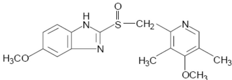
Propriétés physicochimiques : L'oméprazole est une substance cristalline non hygroscopique. Son point de fusion se situe aux alentours de 150 °C, où il y a décomposition. La substance est légèrement soluble dans l'eau. Le pka du benzimidazol est de 8,8 et celui de l'ion pyridinium est de 4,0.
