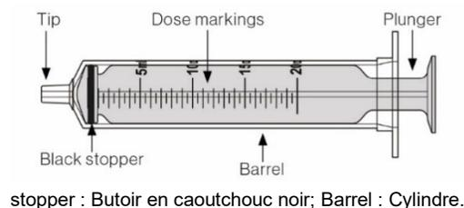
Tip : Embout; Dose markings : Graduations; Plunger : Piston; Black stopper : Butoir en caoutchouc noir; Barrel : Cylindre.
