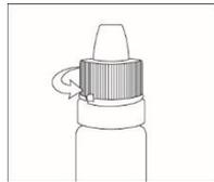
3. Pour ouvrir le flacon, dévissez le bouchon en le tournant. Pour enlever le bouchon, ne le tirez pas directement vers le haut sans le tourner, car cela empêcherait le flacon distributeur de fonctionner normalement.
